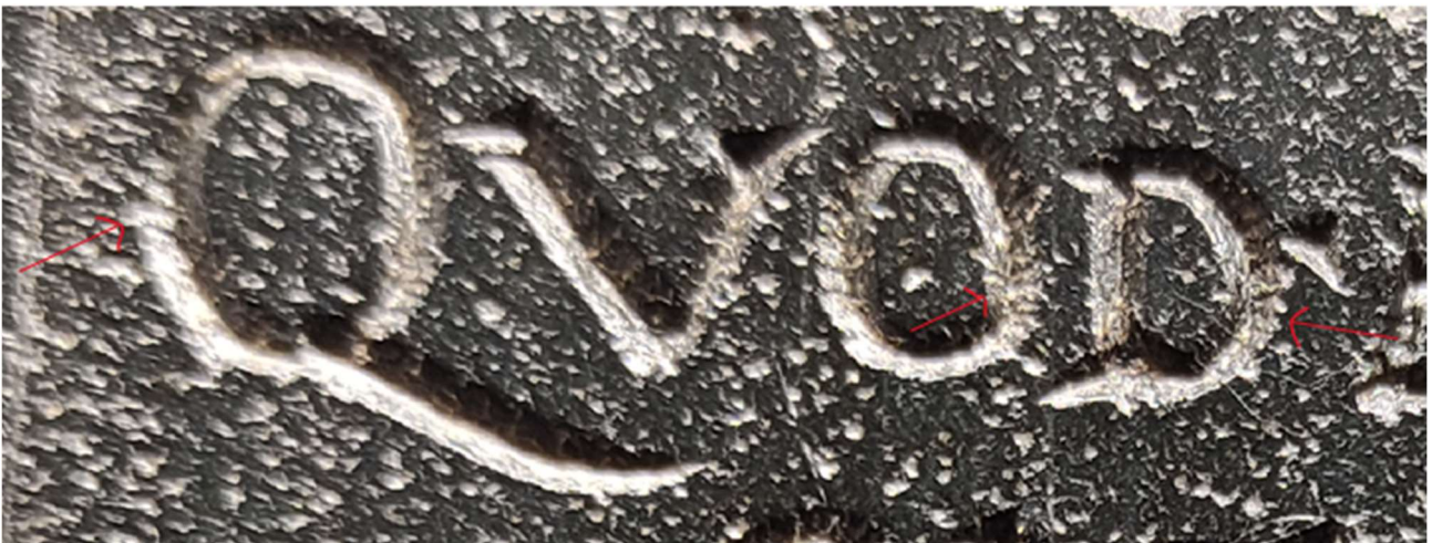
Figura 85: inclusioni sezionate dal bulino. Le più grosse si sono anche scheggiate
