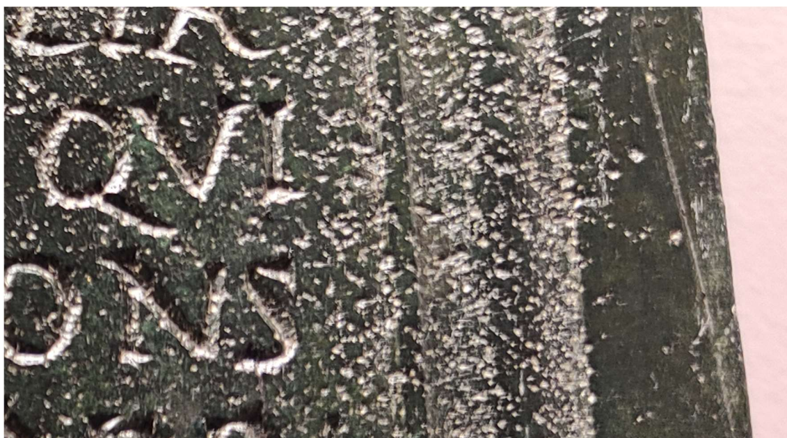
Figura 81: le inclusioni si osservano in tutto lo spessore della soluzione solida piombo-stagno che avvolge l'anima di bronzo puro.
