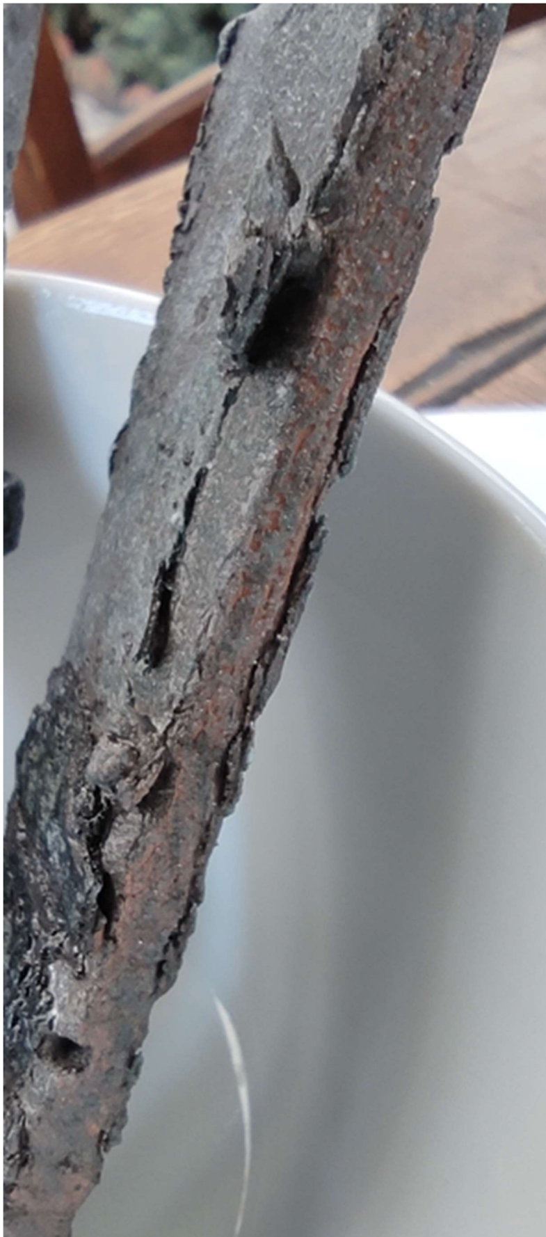
Figura 73: 10/09/2022 striscia Tavoletta appena estratta dopo l'immersione nel liquido delle batterie ad alto contenuto di acido solforico.
