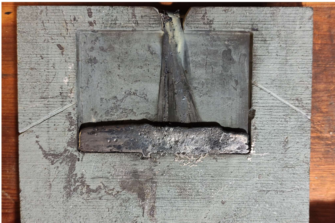
Figura 69 "Bronzo giuridico": Cu 85%, Sn 9%, Pb 6%
