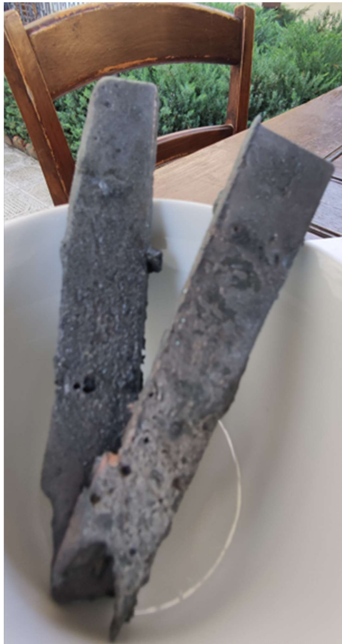
Figura 72: 10/09/2022 striscia Tavoletta e "Bronzo Giuridico" appena estratte dopo l'immersione nel liquido delle batterie ad alto contenuto di acido solforico.
