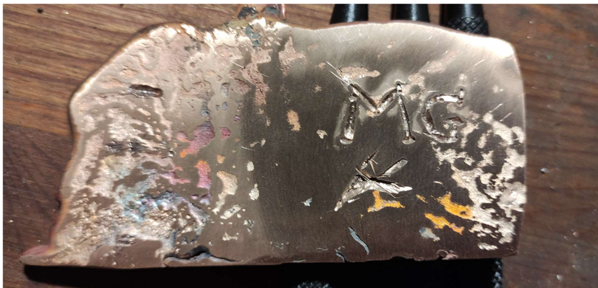
Figura 71: Striscia di colata del “Bronzo Giuridico”, spazzolato delicatamente con spazzola per lucidare le scarpe. Marco Gius ci ha inciso le sue iniziali.
