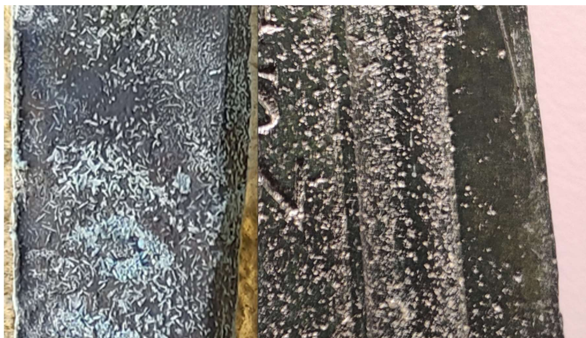
Figura 77: 16/09/2022 A sinistra la striscia della Tavoletta invecchiata artificialmente da 5 giorni, a destra la Tavola Clesiana scoperta nel 1869, ovvero 155 anni fa (particolare del lato destro in corrispondenza della bocca di colata).
